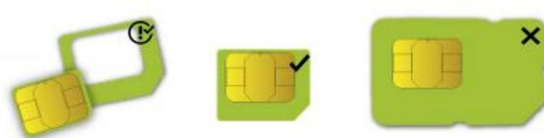
Lo slot per schede SIM è progettato per essere utilizzato con schede Micro SIM.
